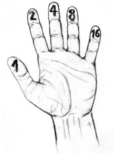
Abbildung 1: Idee von Lisa zum Binärzählen mit den Fingern. Die Finger sind mit Zweierpotenzen beschriftet.
