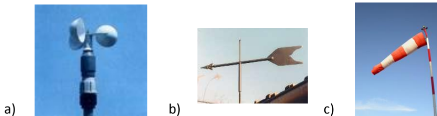
Abbildung 19: Beispiel eines Anemometers (a), einer Windfahne (b) und eines Windsacks (c) ( www.meteole.net )
